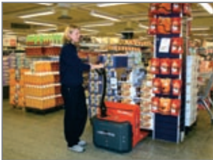
Panther Mini (Tragkraft 1400 kg) ist für leichten Paletten-transport, z.B. in Supermärkten und in Lägern, gut geeignet.
