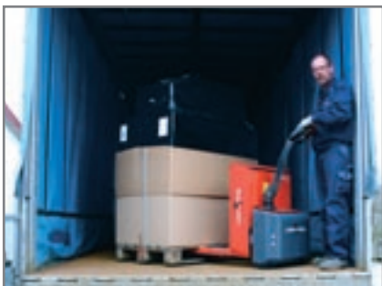
Panther Maxi (Tragkraft 1800 kg) ist für schweren Paletten-transport, z.B. für Speditionen, gut geeignet.
