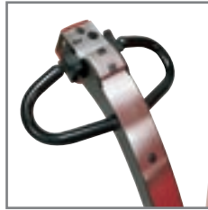
Manövrieren mit der Deichsel in aufrechter Stellung möglich. Alle Funktionen sind in der Deichsel integriert.
