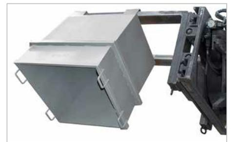
UC-Entleerung mit Stapler-Drehgerät
