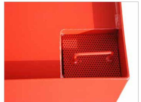
Absaugöffnung und Füllstandsanzeige
