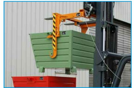
Behälter für Traverse/Drehgerät
