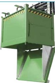
Behälter mit Bodenklappen bieten bei der kompakten Bauform ein optimales Füllvolumen, und durch den günstigen Lastschwerpunkt ist eine volle Ausnutzung der Staplertragfähigkeit möglich. Der große Öffnungsbereich der einteiligen Bodenklappe bietet dabei eine vollständige Entleerung auch bei sperrigem Material mittels Zugseilentriegelung.
