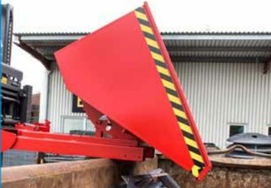
Neben dem Abrollmechanismus haben diese Behälter noch eine automatische Entriegelung. Durch Aufsetzen auf oder durch Druck gegen den Containerrand wird der Behälter entriegelt. Das Handling mit dem Zugseil entfällt.
