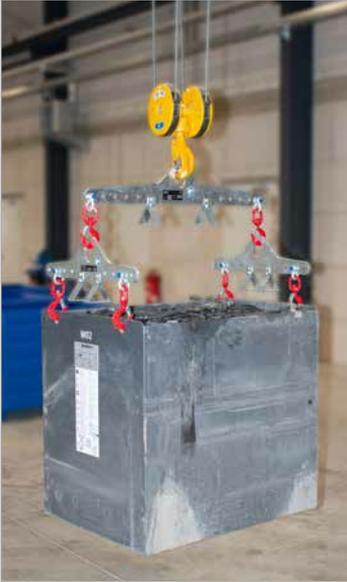
Kombination aus mehreren Traversen zur H-Traverse
