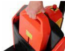
Niedriges Batteriegewicht (nur 4,5 kg) und hohe Qualität – die Lithium Batterie lässt sich schnell austauschen.
