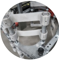
Sonder-entwickelte Greifer aus Polyurethan
